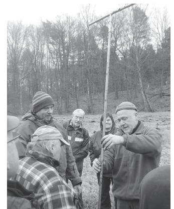
oberflächennahe Moorkörperbohrung im Finowtal. Mit einem transportablen Bohrgestell, einer polnischen Moorklappsonde, nahm Dr. Gärtner mehrere Bohrungen bis zu einer Tiefe von 3 Metern vor.
