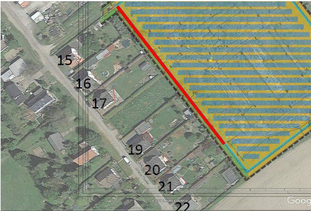
Abbildung 19: Lage und Ausdehnung des Blendschutzes durch breite rote Linie gekennzeichnet
