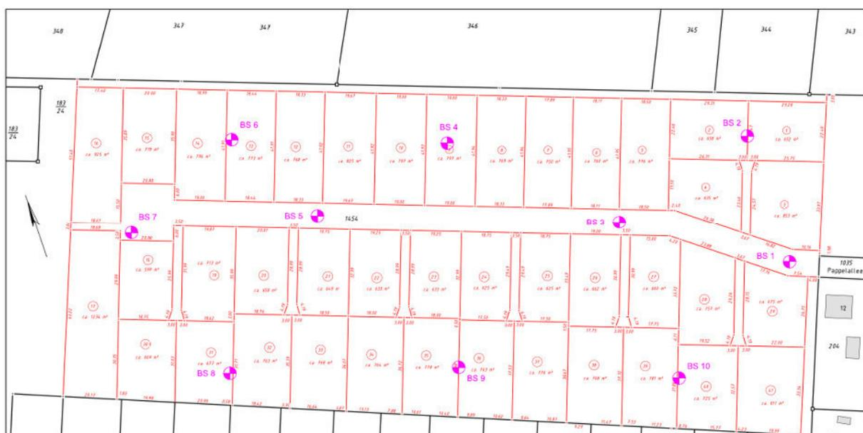
Abbildung 6: Lageplan der Rammkernsondierungen (BS 1 – BS 10)
