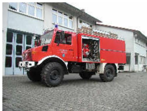
BILD A13.3 Abbildung 5: GW-N mit fest eingebaute Beleuchtung und B-Schläuchen in Rollcontainern [Ingo Horn]
