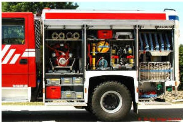
BILD A14.5 Unterbringung der Zusatzausstattung "Wasserrettung" in einem Löschfahrzeug (Ausführungsbeispiel)
