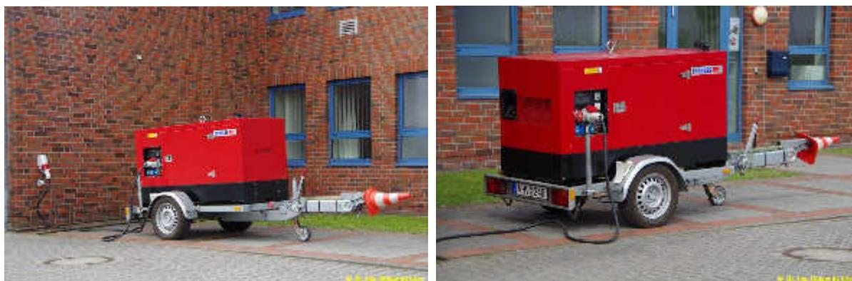
BILD 6.4 Für ausgewählte Feuerwehrehäuser wird Noteinspeisung empfohlen. Für die Stromerzeugung werden Anhänger empfohlen, die mit Lichtmast oder -ballon ausgestattet werden sollten, um im normalen Einsatzdienst zur Ausleuchtung von Einsatzstellen verwendet werden zu können.
