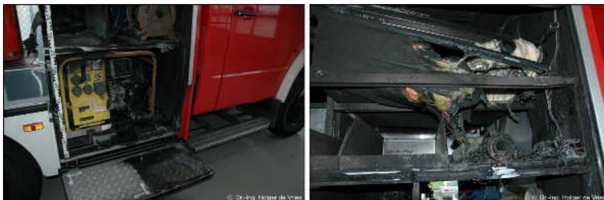
BILD 6.3 Brandschaden an einem Löschfahrzeug
