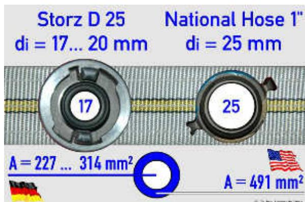
BILD A7.1 Der Nachteil deutscher D-Storz-Kupplungen liegt in der Halbierung der Querschnittsfläche im Bereich der Einbindestutzen und Dichtung.
