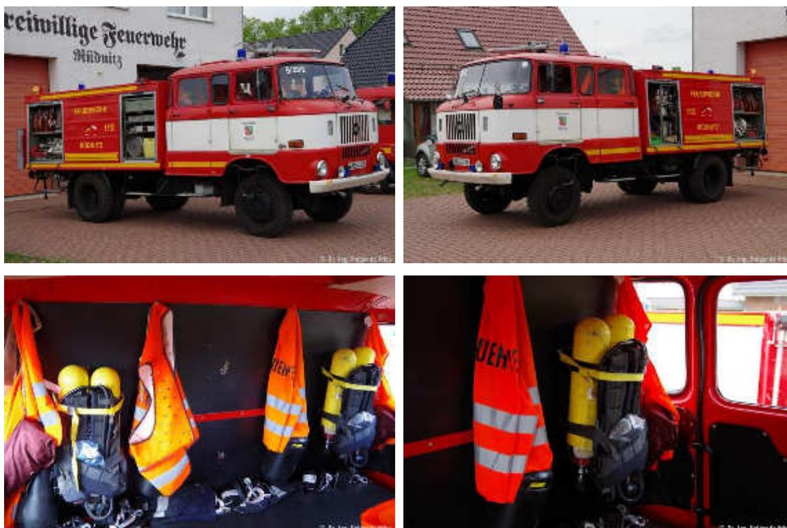
BILD 6.5 Die Mannschaftskabinen der beiden Tanklöschfahrzeuge auf IFA-Fahrgestell entsprechen in keinsten Weise den Regeln der Technik.
