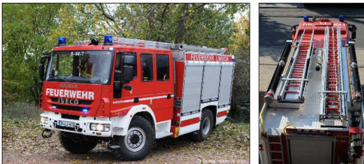
BILD A6.3 Saugleitung und Saugkorb vorgekuppelt verlastet auf Fahrzeugdach
