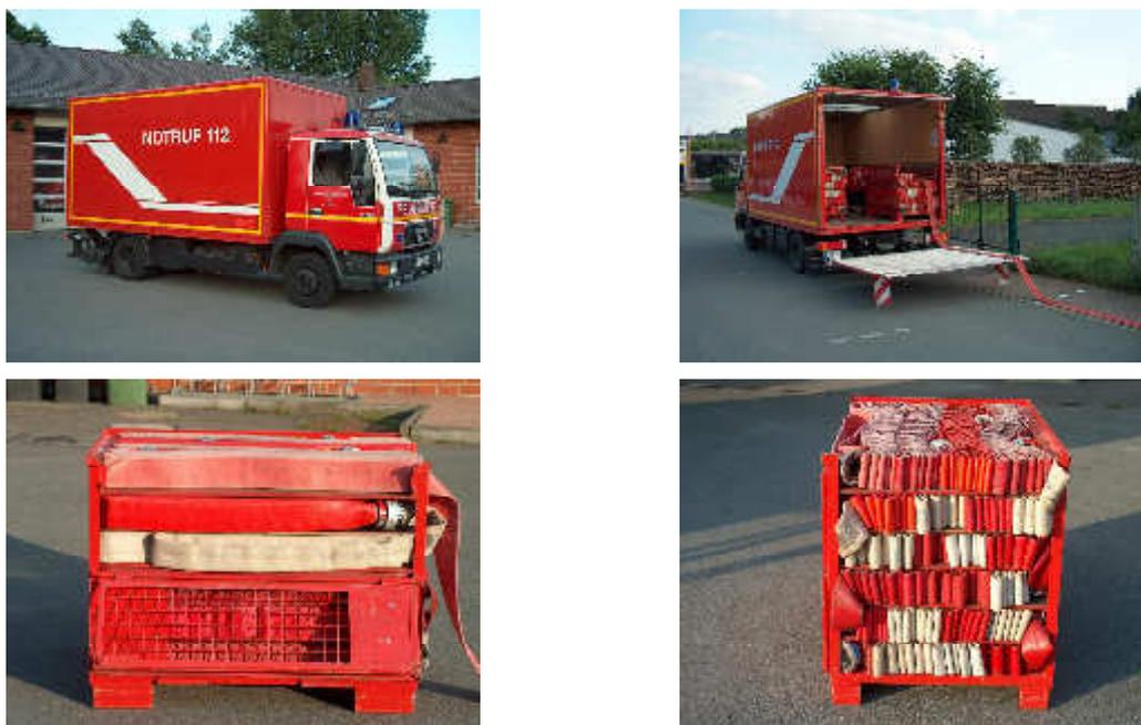
BILD A13.4 GW-N der FF Fuldataal mit B-Schläuchen in Buchten in Gitterboxen [Stefan Finger, Fuldataal]
