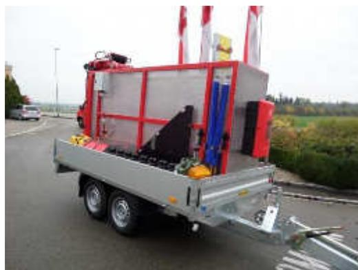
BILD 3.2 a und b: Schlauchverlegeanhänger (Ausführungsbeispiele)
