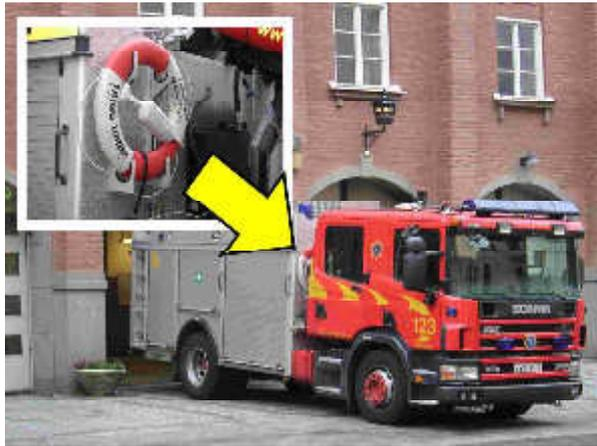
BILD A14.3 Bei der Feuerwehr Stockholm befindet sich zwischen Kabine und Gerätekoffer griffbereit ein Rettungsring
