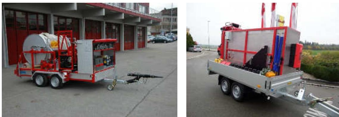
BILD 6.9 a und b: Schlauchverlegeanhänger (Ausführungsbeispiele)
